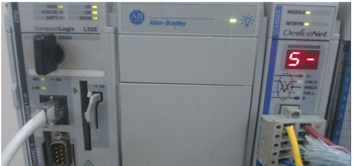
Hình 10: Bộ điều khiển đang làm việc ở chế độ Secondary trong mạng Devicenet
