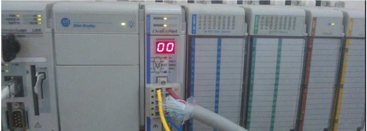
Hình 7: Bộ điều khiển hoạt động ở chế độ không có chức năng dự phòng cho Master trong mạng Devicenet
