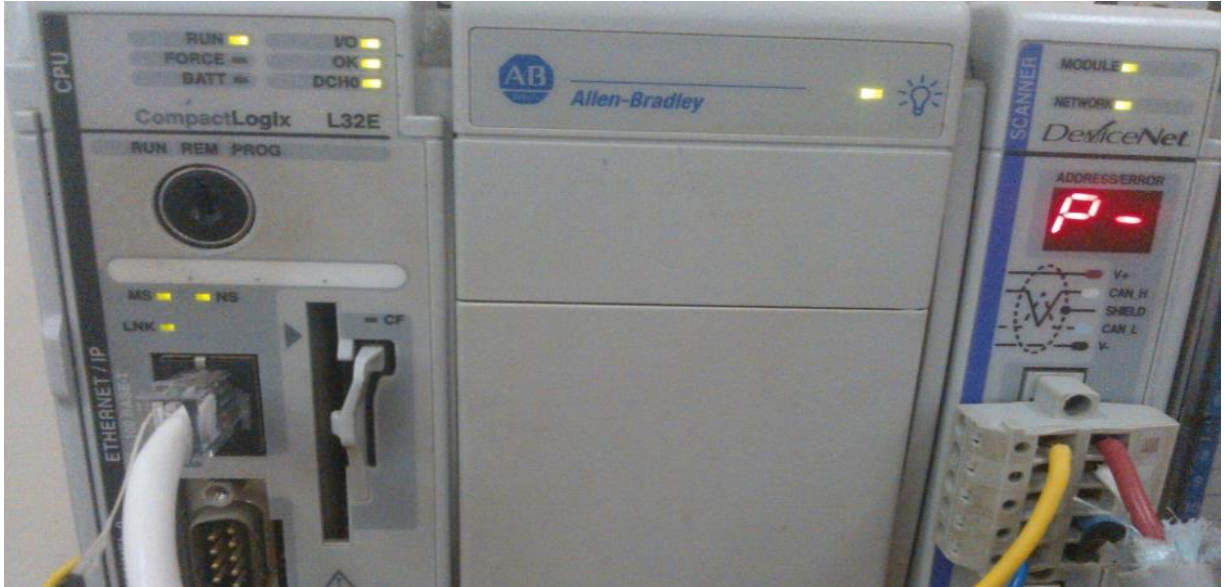
Hình 9: Bộ điều khiển đang làm việc ở chế độ Primary trong mạng Devicenet
